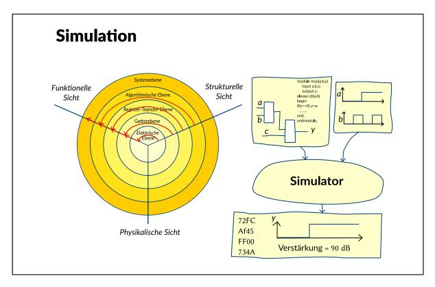
Simulation bedeutet, ein (Software-)Modell der Schaltung zu benutzen, um ihr Verhalten zu analysieren. Dazu werden die Eingänge des Schaltungsmodells mit Signalwerten (so genannten Stimuli) belegt und die berechneten Werte an den Ausgängen (oder auch an beliebigen Stellen innerhalb der Schaltung) beobachtet.
