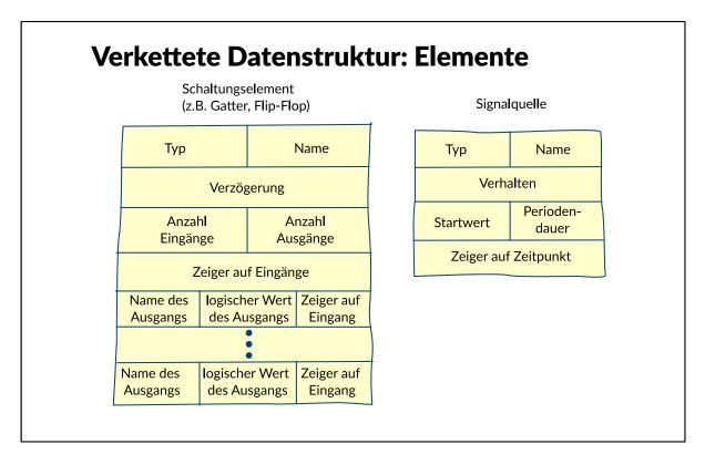
Elemente und Signale können durch geeignet aufgebaute Datensätze, wie hier beispielhaft gezeigt, beschrieben werden. Sie werden durch entsprechende Zeiger miteinander verkettet, so dass vollständige Schaltungen mitsamt der Stimuli beschrieben werden können.
