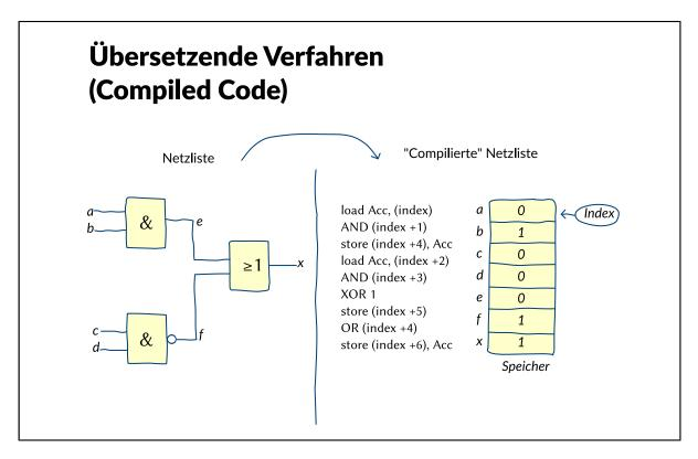
Zwar kann grundsätzlich jedes Modellierungskonzept, d.h. eine Schaltung auf beliebigen Ebenen des Y-Diagramms, in ausführbaren Programmcode umgesetzt werden, i.a. jedoch unterliegen übersetzende Verfahren (Compiled-Code-Simulation) insbesondere folgenden Einschränkungen:
