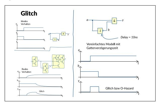
Ein Glitch oder ein so gennanter Hazard ist ein aufgrund unterschiedlicher Signallaufzeiten in den Pfaden einer Schaltung bedingte kurz Änderung des logischen Pegels. Ein 0-(1-)Hazard ist ein 1-(0-)Impuls auf einem Signal, welches aufgrund der logischen Funktion ständig 0(1) sein sollte.
