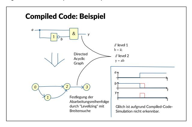
Im ersten Beispiel wurde lediglich die Simulation eines Eingangsmusters beschrieben. Es ist jedoch leicht auf eine beliebige Folge von Eingangsmustern zu erweitern. Fügt man zusätzlich simulierte Register ein, können auch sequentielle Schaltungen simuliert werden.
