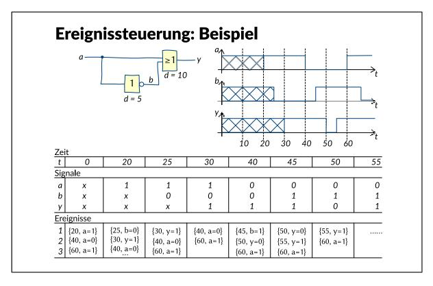
Das Bild zeigt den groben Ablauf einer ereignisgesteuerten Simulation für das bereits bei der Compiled-Code-Simulation betrachtete Schaltungsbeispiel. Im Zeitdiagramm ist ein Pegeleinbruch (Glitch) bei t=50 zu erkennen. Mit dem verwendeten Simulator können also - anders als beim einfachen Compiled-Code-Verfahren - mit Hilfe eines Transport-Delay-Zeitmodells Timing-Probleme solcher Art erkannt werden.
