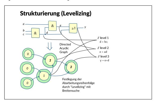
Um sicher zu stellen, dass kein logischer Wert eines Gatters verwendet wird, bevor er endgültig berechnet wurde, erfordert die Compiled-Code-Simulation eine Strukturierung der Schaltung in logische Ebenen (Levelizing). Auf diese Weise wird die (real parallel arbeitende) Schaltung in eine Sequenz von Rechnerschritten abgebildet.
