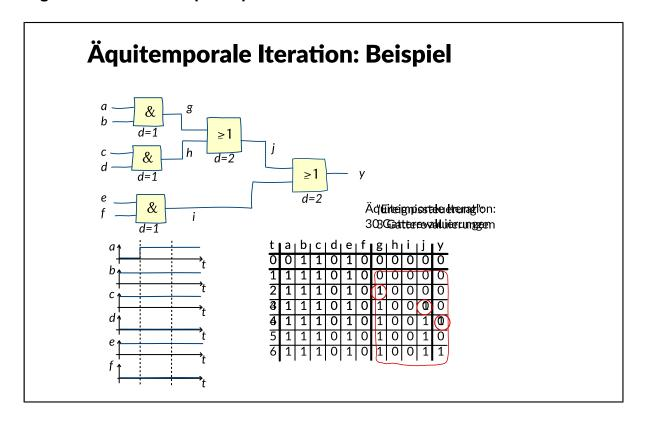
Bei der äquitemporalen Iteration wird für jeden Zeitpunkt die gesamte Schaltung untersucht, d.h. jedes Element wird ausgewertet. Anschließend wird die Zeit inkrementiert. Die Schrittweite kann sich ggf. von Iteration zu Iteration ändern. Sie ist jedoch stets für alle Schaltungselemente dieselbe.
