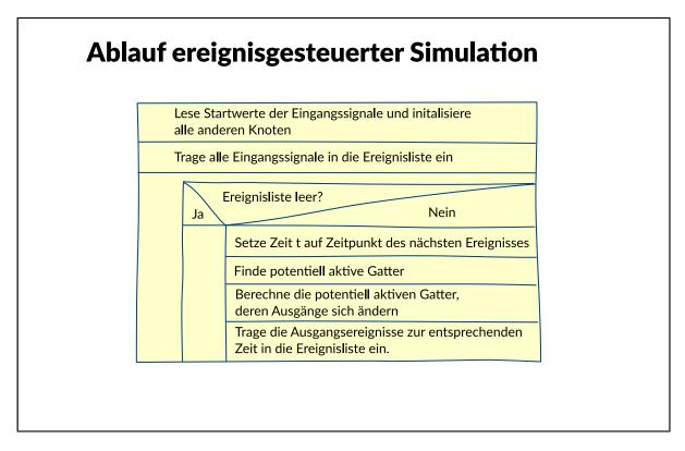
Mit den geschilderten Datenstrukturen ergibt sich der allgemeine Ablauf wie folgt: Zunächst werden alle Schaltungseingänge mit vorgegebenen Werten initialisiert. Alle anderen Netze werden auf X gesetzt. Das Zeitrad wird mit t0 initialisiert. Zu Beginn der Simulation sind alle mit den Schaltungseingängen verbundenen Elemente potentiell aktiv. Für jeden Zeitschritt des Zeitrads werden nun folgende Schritte ausgeführt:
