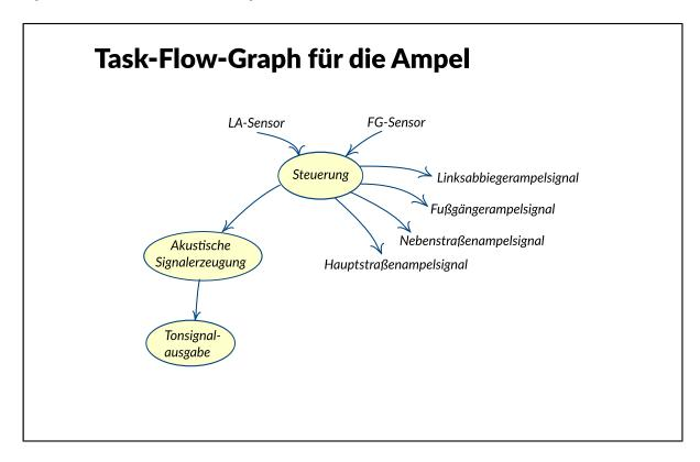
Die Abbildung zeigt den Taskflow-Graphen für die Ampelsteuerung. Der Datenfluss besteht hier in der Signalisierung, dass etwas bestimmtes ausgeführt werden muss.
