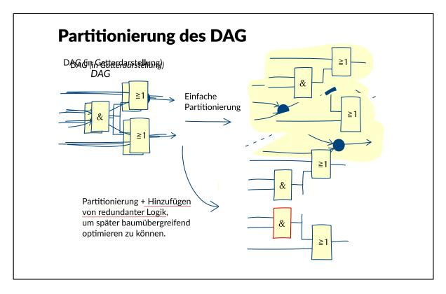
Ein einfacher Weg, den DAG in Bäume zu zerlegen, besteht darin, alle Verzweigungen aufzutrennen und anschließend alle Bäume einzeln abzudecken. Der Nachteil davon ist, dass beim Abdecken nur lokal innerhalb eines Baums optimiert werden kann und nicht baumübergreifend.
